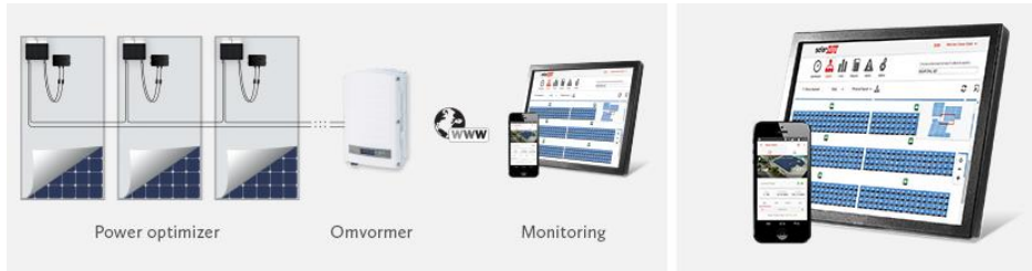
Afbeelding 5: Het SolarEdge systeem met monitoring
